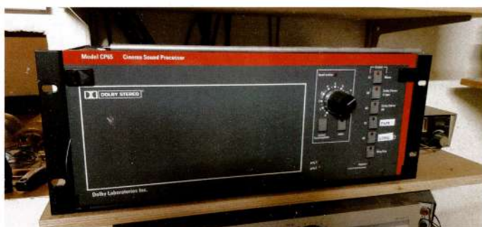
Dolby CP65 Prozessor für Lichtton Mono, Lichtton Dolby Stereo A und Lichtton Dolby Stereo SR sorgen für den guten Ton bei 35mm.
