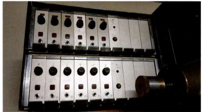
Magnetisch: 2 x 6 Magnettonvorverstärker sind notwendig, um Magnetton-Filmkopien von zwei Filmprojektoren wiedergeben zu können.
